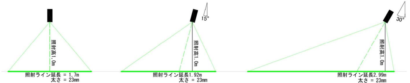
※ 照射距離によって、照射ラインの延長および太さが比例して変化します
